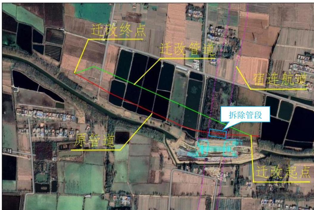
图 3.4-12 旧管道处置情况示意图
