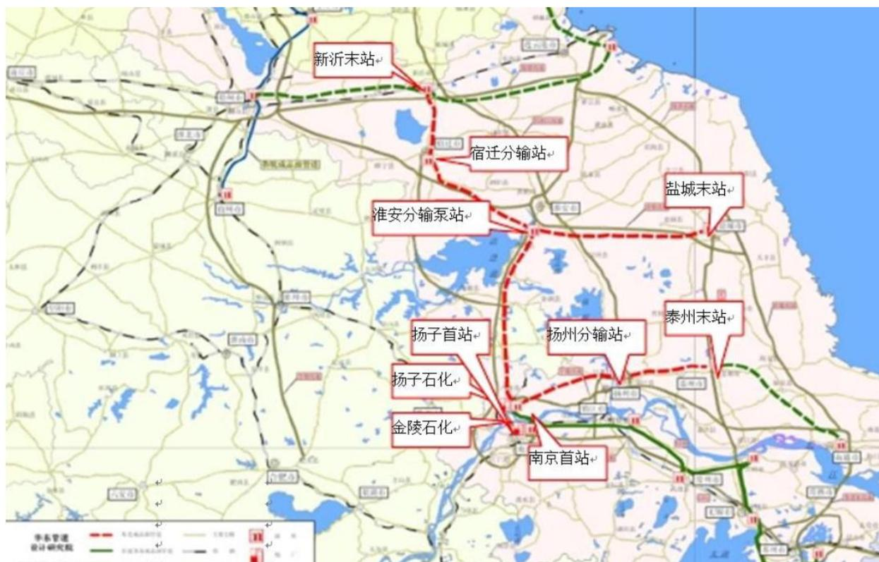
图 3.1-1 苏北成品油管道工程线路走向图
