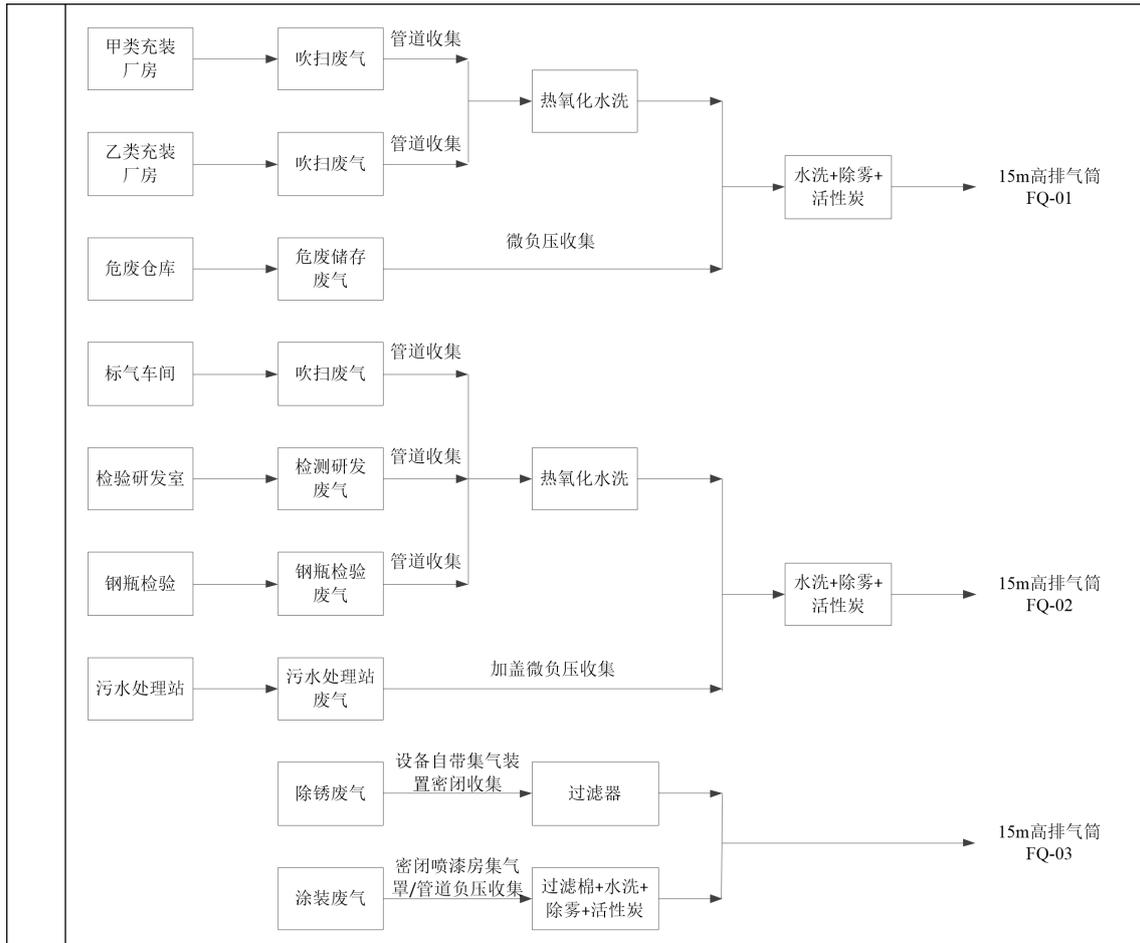
图 4-2 全厂废气收集、治理、排放措施示意图
