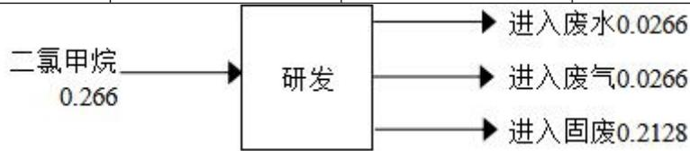
图 3.2-6 二氯甲烷物料平衡图 (t/a)
