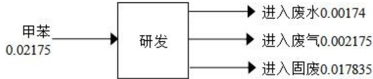
图 3.2-5 甲苯物料平衡图 (t/a)
