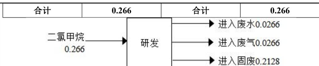
图 2-6 二氯甲烷物料平衡图 (t/a)
