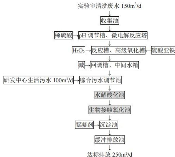
图 4-1 研发中心污水处理站工艺流程图
