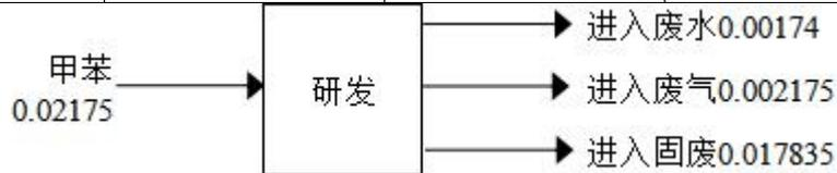
图 2-5 甲苯物料平衡图 (t/a)
