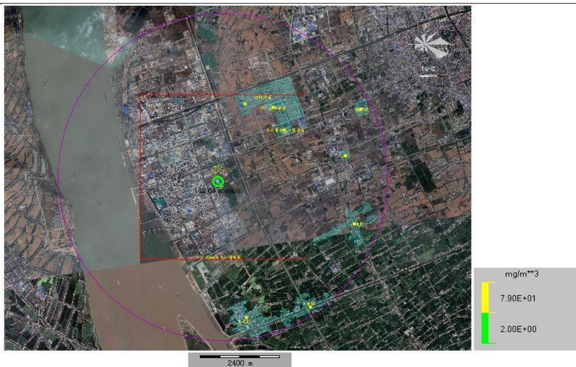
图 6.6-3 发生地最常见气象条件 SO<sub>2</sub> 泄漏扩散影响示意图
