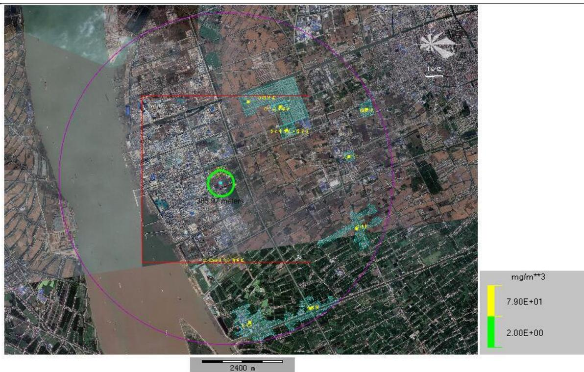
图 6.6-1 最不利气象条件下泄漏 SO<sub>2</sub> 扩散影响示意图
